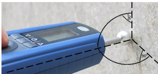
Afbeelding 4-3 Meting zo verticaal mogelijk t.o.v. het meetoppervlak
